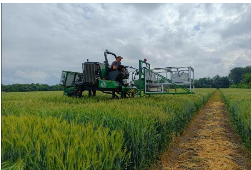
Rysunek 9 System Field-Screen (PSI) zamontowany na nośniku narzędzi Zurn 540, na tle pól doświadczalnych, na których prowadzono fenotypowanie RGB - fenotypowanie kłosów
