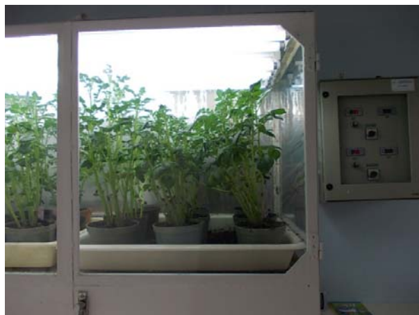
Fot. 1. Fitotron do termoterapii roślin ziemniaka (fot. D. Sekrecka)
